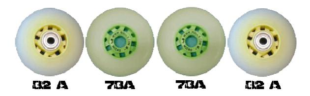
Comme vous pouvez le constater sur ce schéma, les roues centrales sont d'une dureté inférieure. Une solution simple consiste à utiliser des roues plus dures aux extrémités du patin pour qu'elles s'usent moins vite.. Par exemple, du 78 A au centre et du 82 sur les extrémités.
